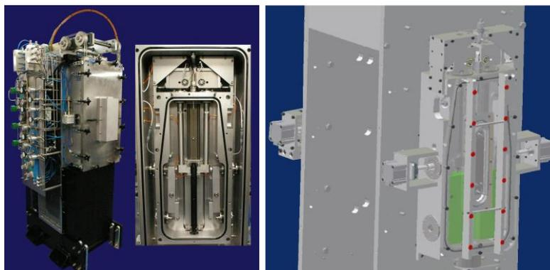
La machine TE 104 originale est conçue pour fonctionner sous hydrogène pressurisé, ce qui augmente considérablement son coût et sa complexité. Un client souhaite un dispositif similaire, mais sans fonctionnement sous hydrogène, pour effectuer des tests sous gaz non explosifs.
