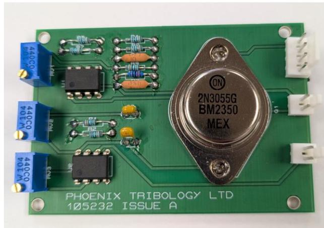
Nous avons aussi un circuit de mesure de faible résistance LCR, qui intègre une source de courant constante, produisant une tension proportionnelle à la résistance du contact tribologique.
