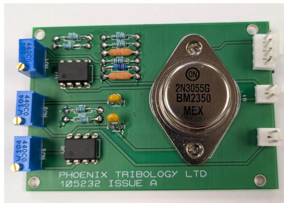
这是 LCR 低电阻测量电路的示意图，它包含一个恒流源，产生与摩擦接触电阻成比例的电压输出。虽然从示意图上看这是一个非常简单的电路，但实际实施起来要复杂一些。
