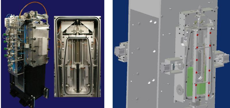
TE 104 摩擦试验机用于加压氢气环境下的摩擦试验，这大大增加了设备的成本和复杂性。我们目前有一位客户想要一台类似的设备，但不需要氢气环境的功能，用于在非爆炸性气体中进行测试。因此，我们移除了TE 104 中氮气腔，所有氢气和防爆组件来实现该目的。后续，我们可提供两款型号，即：
